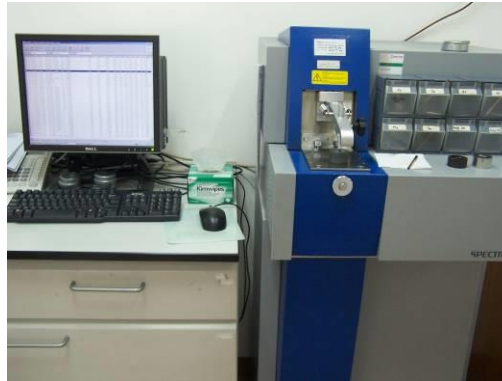
多元素含量的測定 - 火花放電原子光譜法
